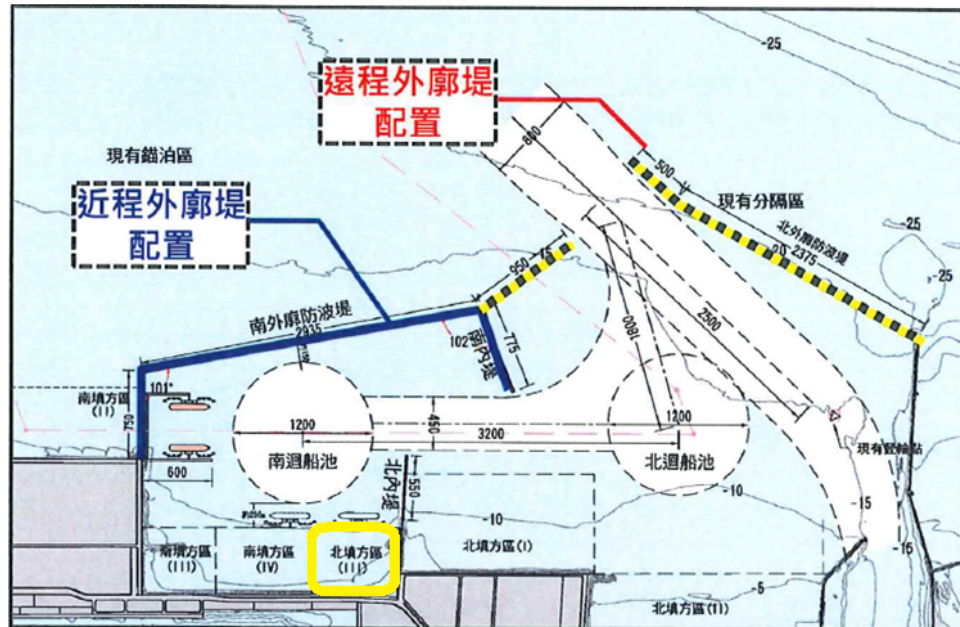
圖 4 臺中港近、遠程外廓防波堤及港型配置規劃
