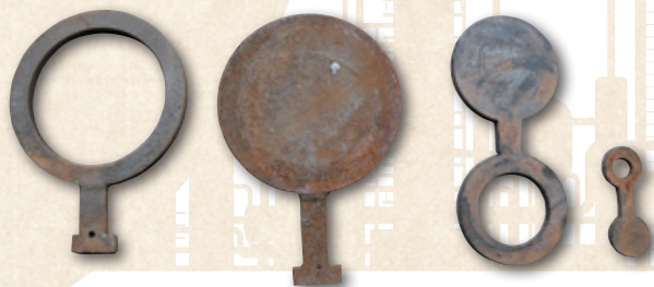
▲各式各樣的盲板，單環上的老鼠尾可判別管線流通狀態；8字形雙環盲板，有實心與空心兩端。（攝影：黃文賢）
