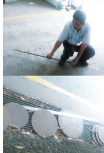
▲左：自製圓規用來製作各種不同規格尺寸的圓形鋼板。 右：自製的○型環內徑量測器，由數層不同尺寸之圓錐堆疊而成，可層層拆卸移動，用於測量墊圈內徑。（攝影：黃文賢）
