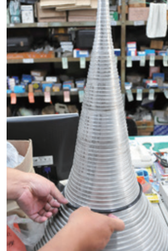
▲左：自製圓規用來製作各種不同規格尺寸的圓形鋼板。 右：自製的○型環內徑量測器，由數層不同尺寸之圓錐堆疊而成，可層層拆卸移動，用於測量墊圈內徑。（攝影：黃文賢）
