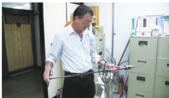
▲通管器密閉設計，阻斷硫化氫外洩，為因公殉職的李俊德工場長設計，手持通管器讓同仁更加緬懷李工場長。（攝影：黃文賢）
