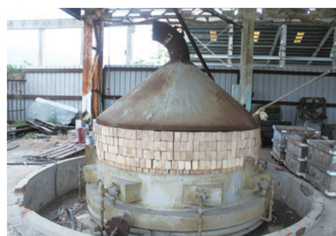
▲以天然氣為燃料的小型熱處理爐，造型特殊目前已少見。（攝影：黃文賢）
