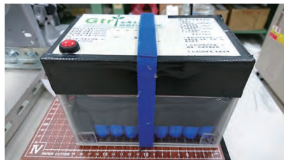
▲本公司綠能所研發的電動腳踏車用的 LTO 電池組（36V/7Ah）。
