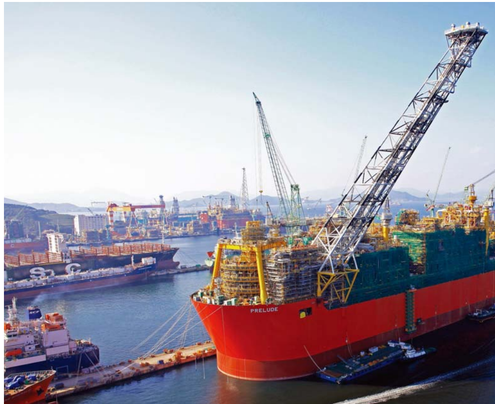
FLNG 是一種用於開發海上天然氣田的浮式生產裝置，具有開採、處理、液化、儲存和裝卸天然氣的功能。
