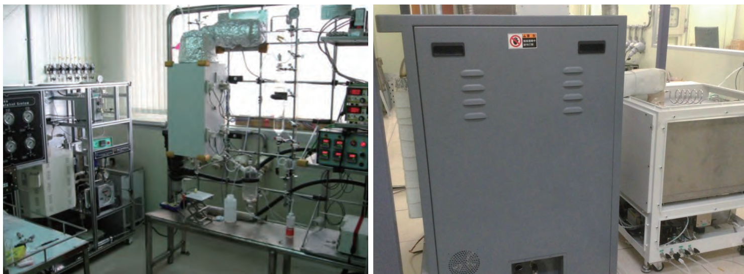
氫能源發展為中油綠能所重點研發項目之一。左圖為重組產氫最適觸媒系統篩選評估設備，右圖為高溫燃料電池系統測試設備。
