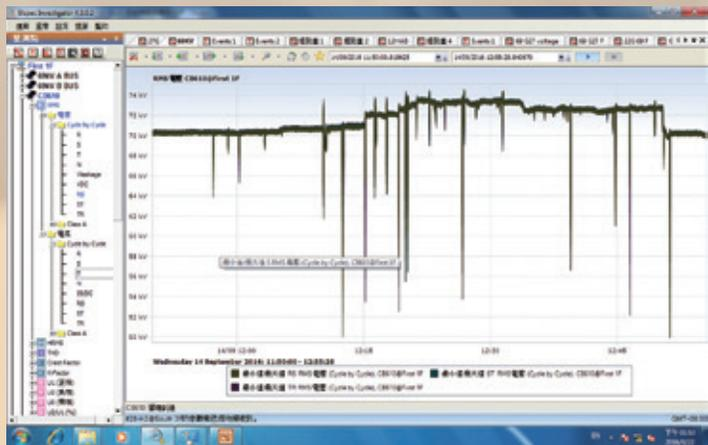
▲圖 1 9/14 莫蘭蒂颱風肆虐，大小壓降事件頻繁，69kV 電壓急遽變化。（資料來源：擷圖自林園石化全時錄波系統-POSCADA）
