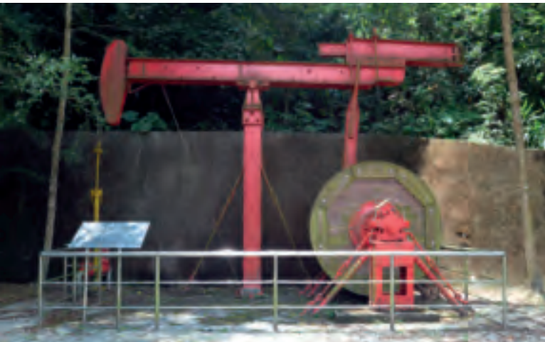
抽油桿式抽油機是出磺礦場開發初期最重要的原油採收設備。
