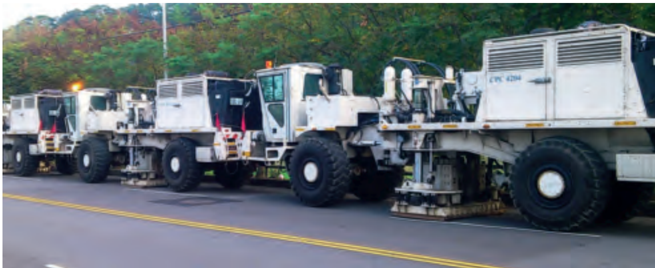
技術演進，震盪震源車施測取代了炸藥方式，是路上探勘的利器。
