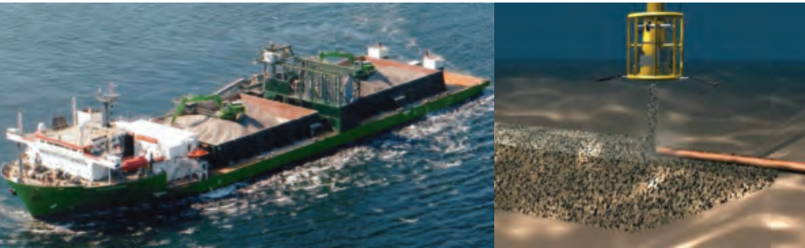
移動式落管船工法 (Fall Pipe Vessel) 可準確、快速地將砂石拋放至海床掏空部位。
