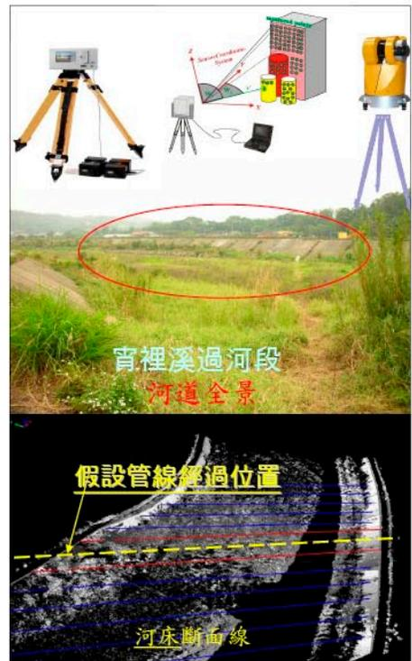
▲過河段管線3D掃瞄測量基礎資料建置3D雷射掃瞄新測繪科技，突破傳統測量的窠臼，可快速掃瞄被測物，不需反射稜鏡即可直接獲得高密度掃瞄點之三維坐標數位資料，呈現出完整且精確的數值模型。可應用在橋樑、土石流、油氣槽、電塔、水壩、古蹟及景觀維護等工程與民生用途。
