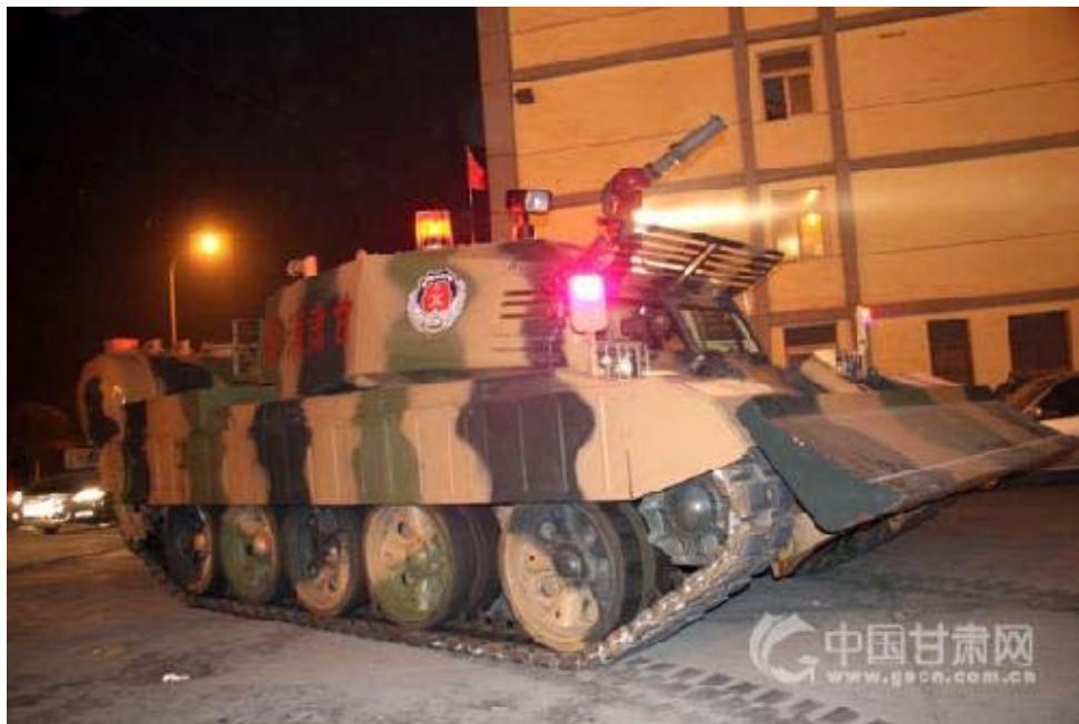
消防坦克開赴火場 (推動力達5噸，最遠水柱射程達70米，具有很強的爬坡和躍溝性能)
