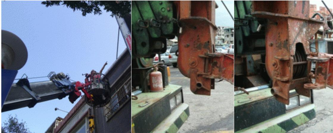
起重機吊掛搭乘設備應由執業 作業前應實施檢點，確認鼻輪一側固定插銷未插
