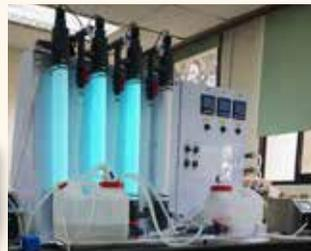
▲高難度廢水廢液高級氧化處理系統。（照片提供／煉製研究所）
