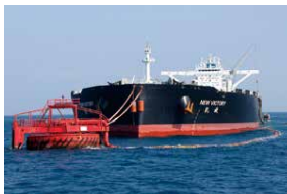
▲陽國鑫卸油工程師(右1)指揮帶纜作業。浮筒班同仁與油輪船工合力把浮筒兩條引纜的大鏈條順利絞緊至油輪甲板上面的繫纜栓。
