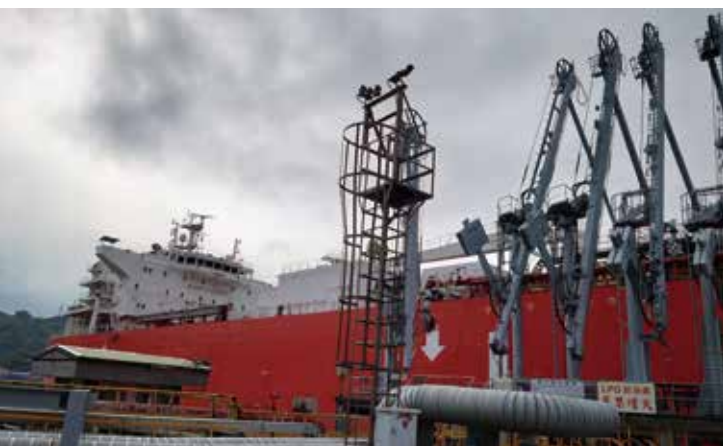
▲從船艙到LPG儲槽仰賴卸料臂操作。
