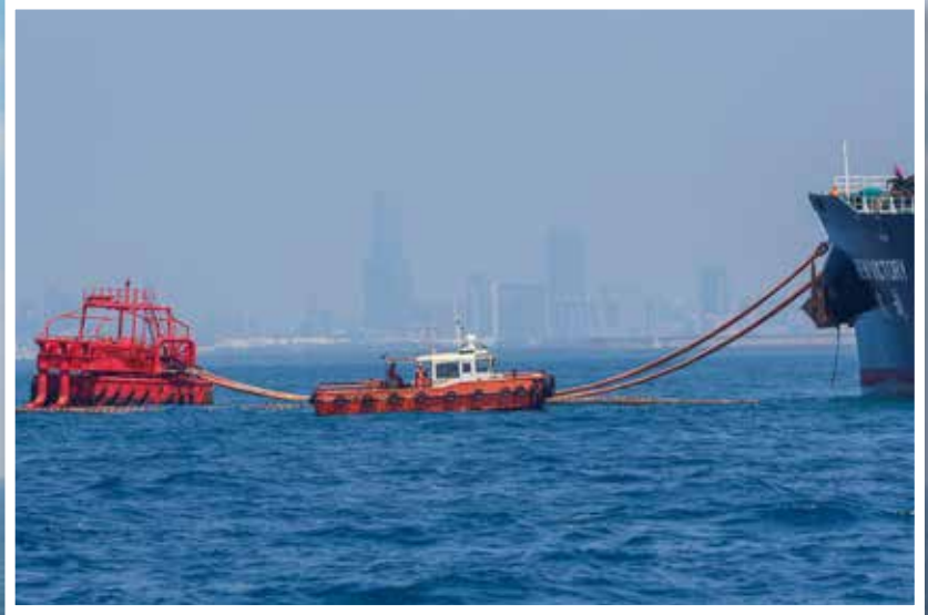
▲小船班同仁肩負將浮筒上的浮蛇管拉靠近原油油輪。
