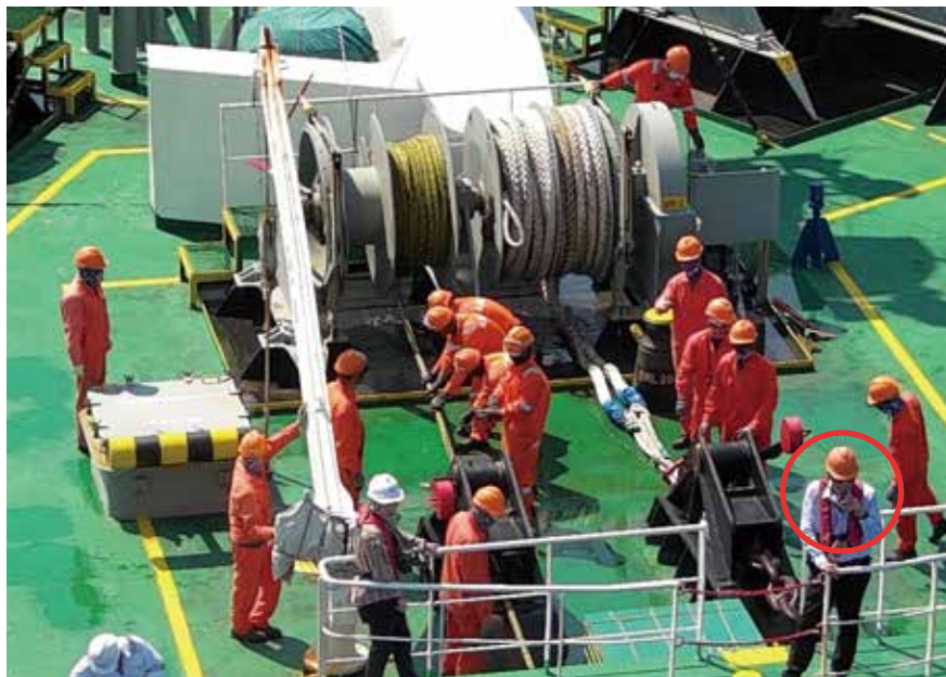
▲陽國鑫卸油工程師(右1)指揮帶纜作業。浮筒班同仁與油輪船工合力把浮筒兩條引纜的大鏈條順利絞緊至油輪甲板上面的繫纜栓。
