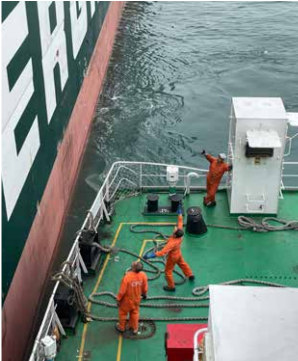
▲油駁船靠泊受油船時，人員在船艙執行帶纜作業。
