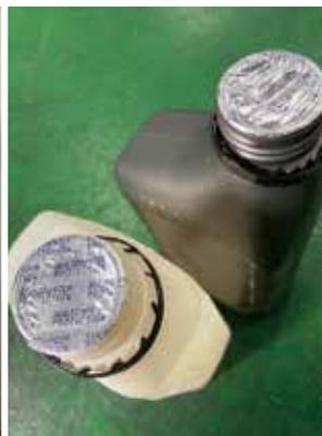
▲經43°C下連續14天模擬環境老化測試後，進行連續3公尺落下測試，瓶身凹陷但無洩漏，瓶口封膜亦無異常。（照片提供／吳錦洲）
