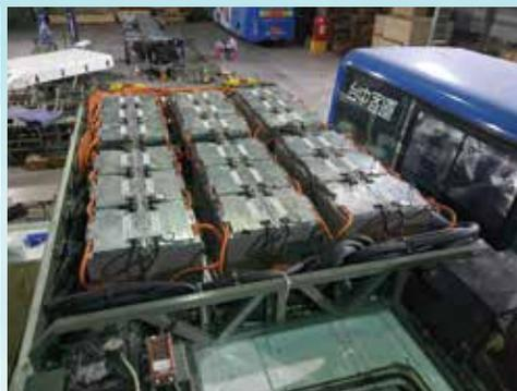
▲圖3C：三支路並聯設計的電池系統。(照片提供／黃瑞雄)
