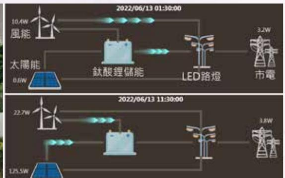
▲圖2C:路燈系統在夜間與白天的電力監測示意圖。(照片提供/劉一平)
