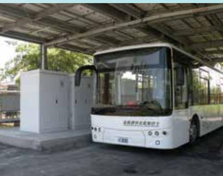
▲圖3A：鈦酸鋰電動巴士及其輔助供電儲能系統。(照片提供／劉一平)
