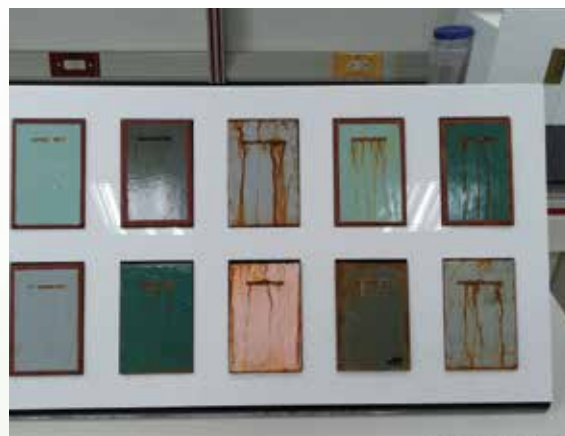
▲上排左1為低VOC環保防蝕塗裝系統，通過ISO CX 4,200 小時測試。
