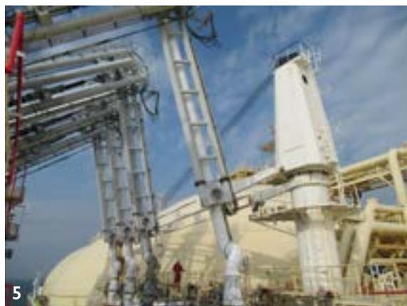
4.5.天然氣經超低溫冷凍至攝氏零下162度，成為液化天然氣（LNG），體積只有天然氣 1/600，便於運輸。圖為 LNG 船靠卸永安港的工作畫面。
