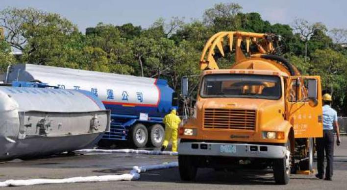
▲亞矽亞儲運公司進行事故槽體殘餘油料移槽，橋頭供油中心支援真空油污吸收車吸附油泥。
