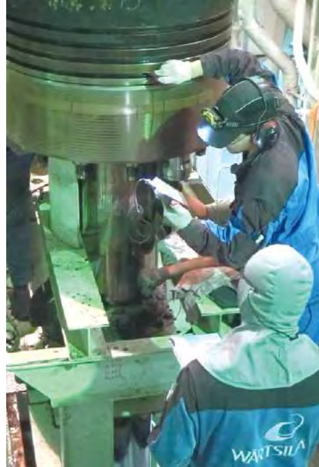
▲WinGD工程師於優明輪進行拆缸量測作業。
