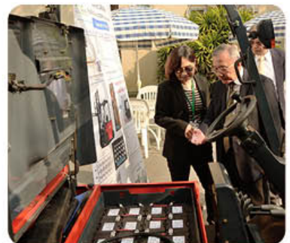
LTO 儲能系統之電動堆高機
