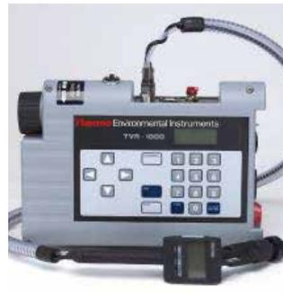
工廠設備元件 VOC 檢測儀
