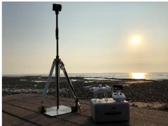
圖 1.10.1-1 Phantom 4 RTK 無人機(右)與 DRTK2 地面基站
