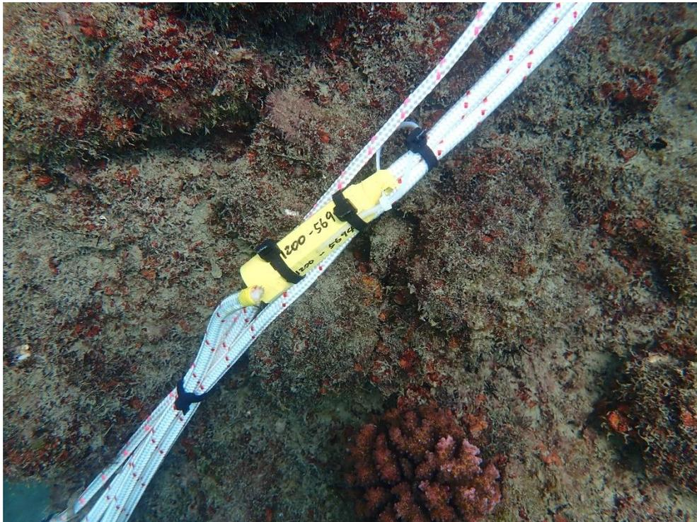
圖 4-3-22、永安 LNG 接收站-北側消波塊-淺處-溫度計佈放
