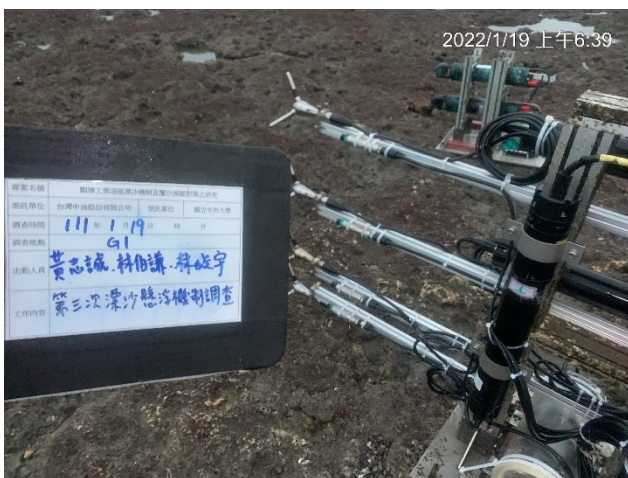
圖 116、111 年 1 月 19 日於 G1 區架設設備現場照片 (左上: Up-looking ADCP 設備照、左下: ADV+OBS 設備照、右上: Down-looking ADCP 設備照、右下: Lisst 設備照)
