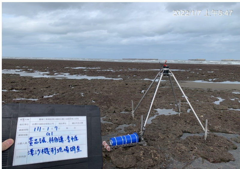
圖 115、111 年 1 月 7 日於 G1 區架設設備現場照片 (上:ADV+OBS 設備照、中:Lisst 設備照、下:Down-looking ADCP 設備照)
