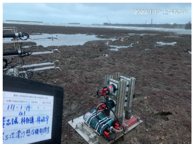
圖 116、111 年 1 月 19 日於 G1 區架設設備現場照片 (左上: Up-looking ADCP 設備照、左下: ADV+OBS 設備照、右上: Down-looking ADCP 設備照、右下: Lisst 設備照)
