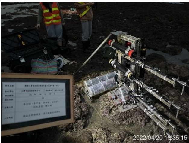
圖 117、111 年 4 月 20 日於 G1 區架設設備現場照片 (左上: Up-looking ADCP 設備照、左下: ADV+OBS 設備照、右上: Down-looking ADCP 設備照、右下: Lisst 設備照)
