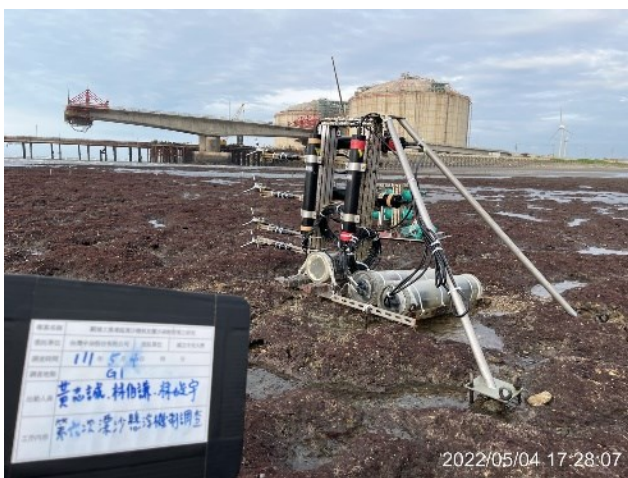
圖 118、111 年 5 月 4 日於 G1 區架設設備現場照片 (左上: Up-looking ADCP 設備照、左下: ADV+OBS 設備照、右上: Down-looking ADCP 設備照、右下: Lisst 設備照)
