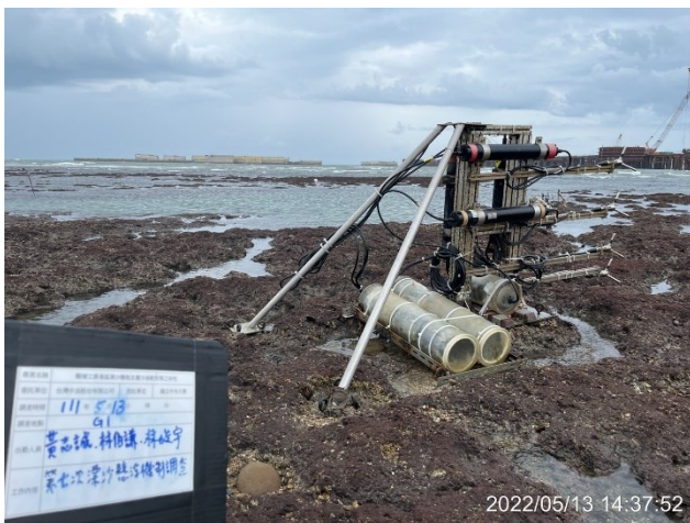
圖 119、111 年 5 月 13 日於 G1 區架設設備現場照片 (左上: Up-looking ADCP 設備照、左下: ADV+OBS 設備照、右上: Down-looking ADCP 設備照、右下: Lissat 設備照)
