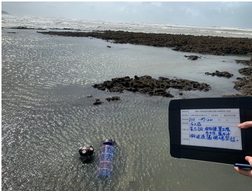
圖 59、G2 區潮波流設備器現場照片
