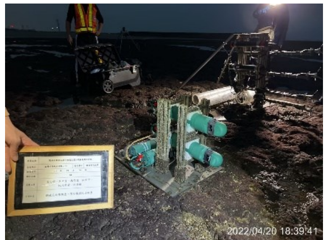
圖 117、111 年 4 月 20 日於 G1 區架設設備現場照片 (左上: Up-looking ADCP 設備照、左下: ADV+OBS 設備照、右上: Down-looking ADCP 設備照、右下: Lisst 設備照)
