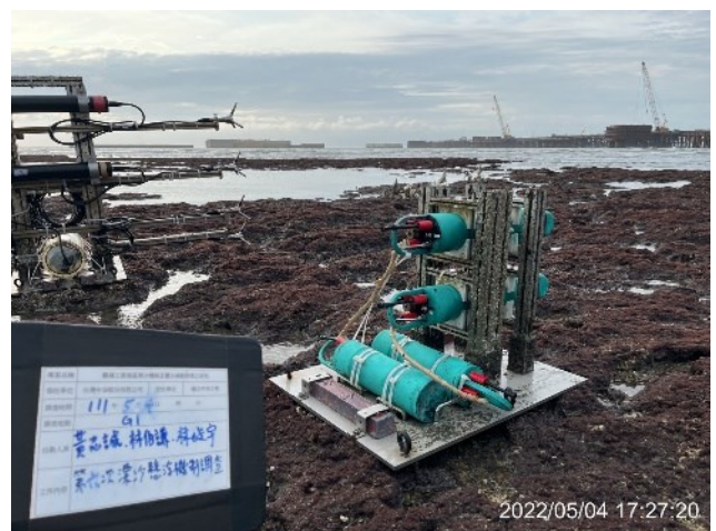
圖 118、111 年 5 月 4 日於 G1 區架設設備現場照片 (左上: Up-looking ADCP 設備照、左下: ADV+OBS 設備照、右上: Down-looking ADCP 設備照、右下: Lisst 設備照)
