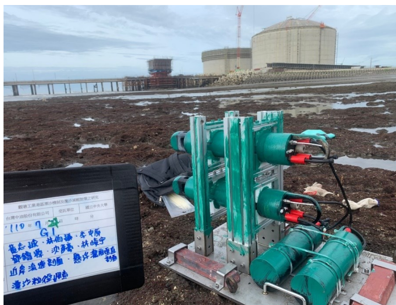
圖 114、110年7月23日~7月24日於G1區架設設備現場照片 (上:現場作業照、中:ADV+OBS設備照、下:Lisst設備照)
