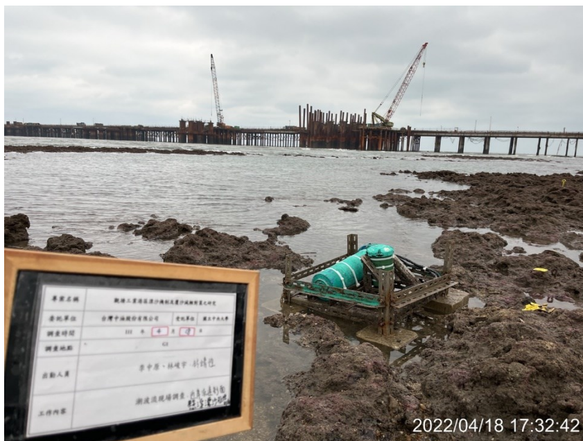
圖 35、G1 區第五次(111/1/6~111/4/18)潮波流儀佈放現場照片 (上圖:設備佈放, 下圖:設備回收)
