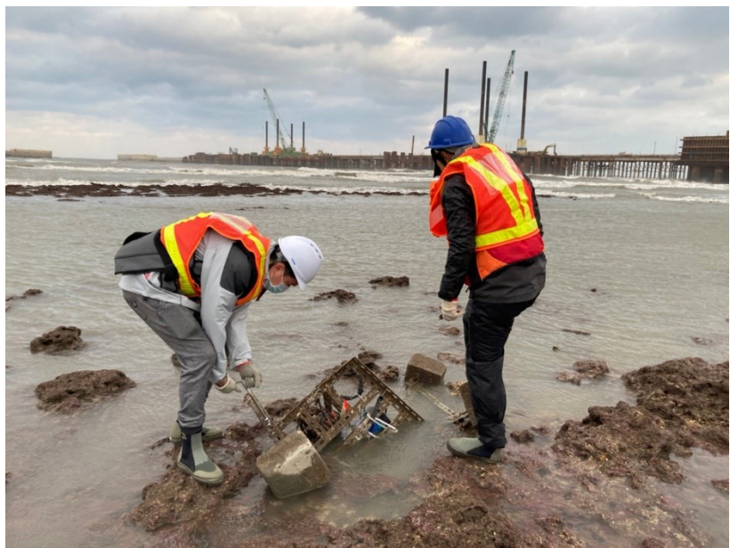
圖 33、G1 區第三次(110/8/23~110/11/9)整合式潮波流儀佈放現場照片 (上圖:設備佈放, 下圖:設備回收)
