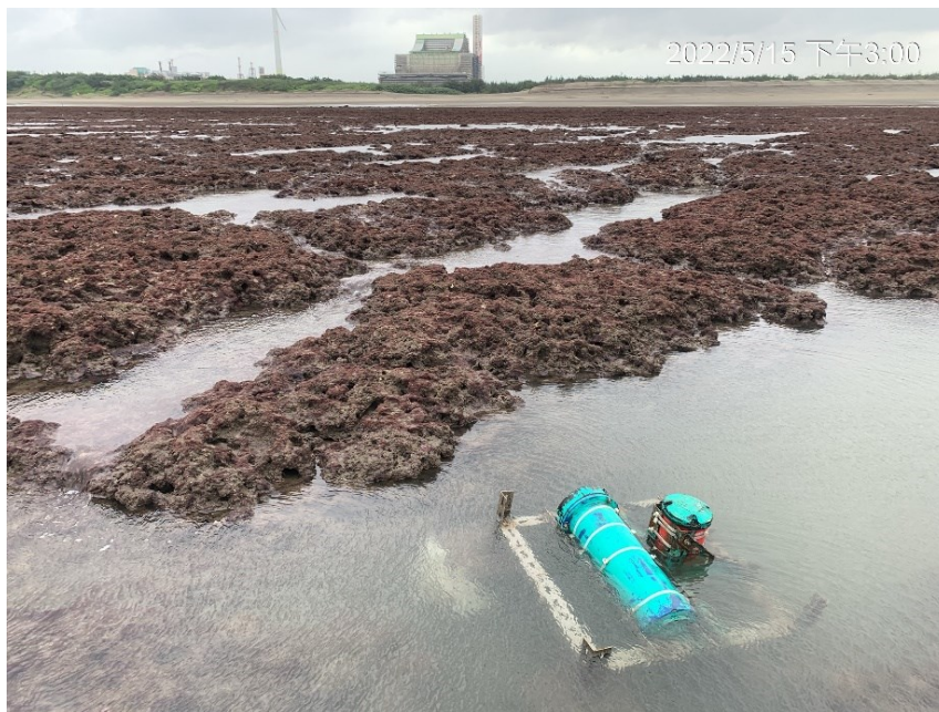
圖 64、G2 區第四次(111/3/31~111/5/15)潮波流儀佈放現場照片 (上圖:設備佈放, 下圖:設備回收)
