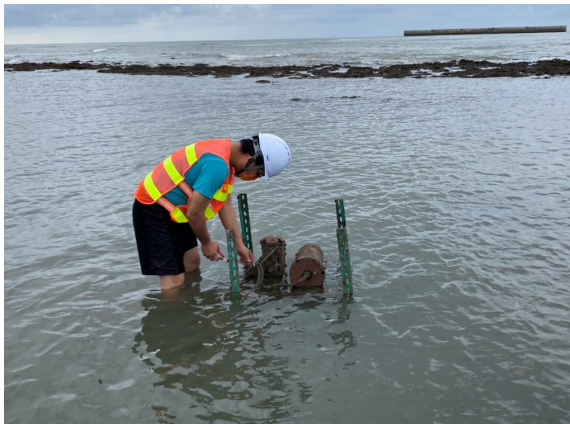
圖 31、G1 區第一次(110/4/27~110/6/24)潮波流儀佈放現場照片 (上圖:設備佈放, 下圖:設備回收)
