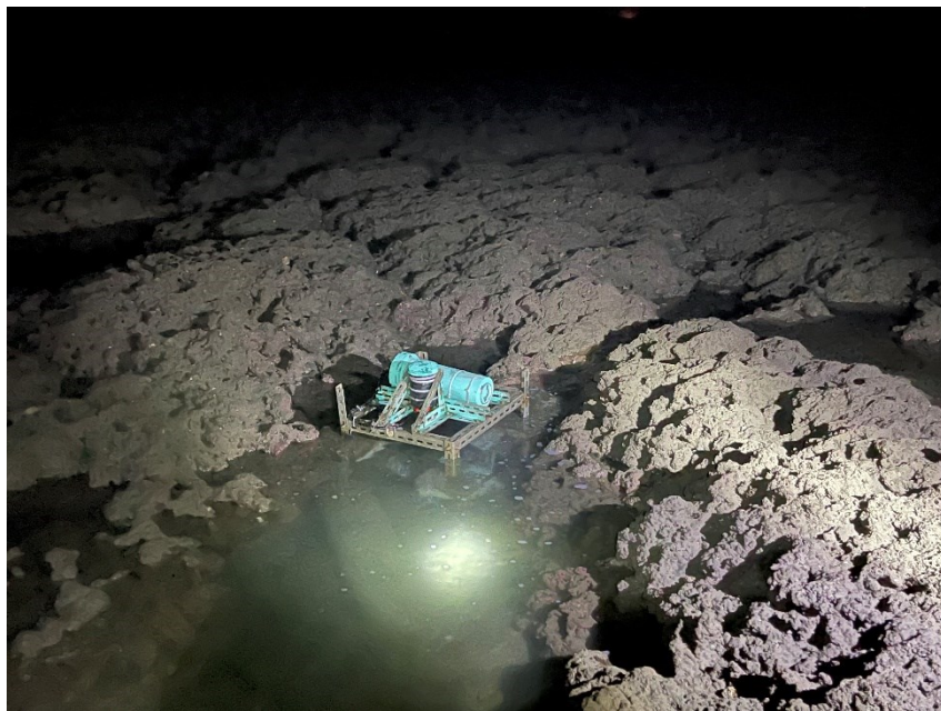
圖 62、G2 區第二次(110/10/5~110/12/3)潮波流儀佈放現場照片 (上圖:設備佈放，下圖:設備回收)
