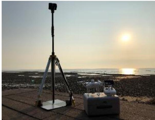
圖 1.10.1-1 Phantom 4 RTK 無人機（右）與 DRTK2 地面基站
