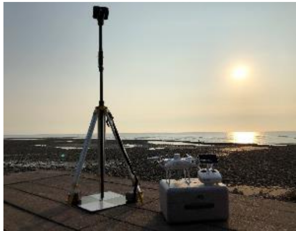
圖 1.10.1-1 Phantom 4 RTK 無人機 (右) 與 DRTK2 地面基站
