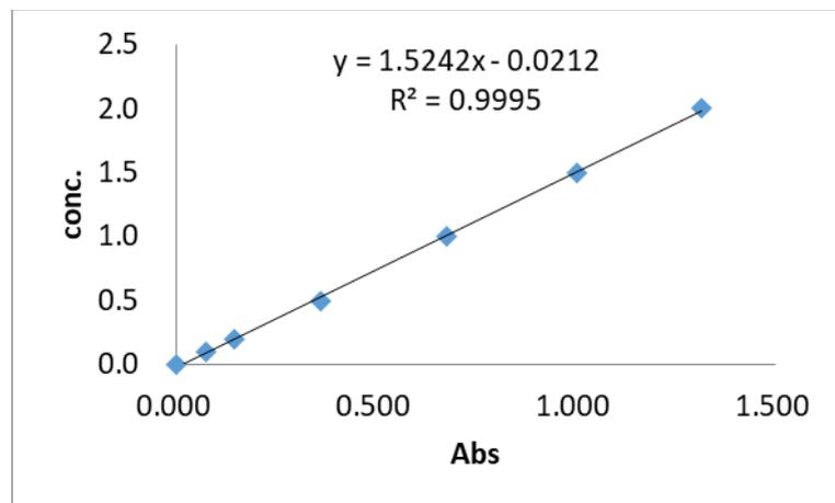
圖 3：矽酸鹽測定之檢量線
