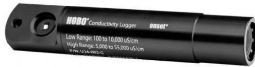
圖 5：自計式溫鹽紀錄儀（型號 HOBO U24-002-C）
