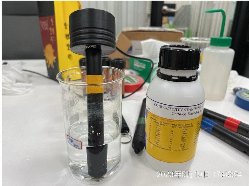
圖 2、導電度探頭校正工作照。
