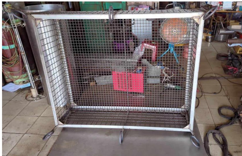
圖 3-3. 珊瑚養殖籃。尺寸為長 1.5 公尺×寬 1.2 公尺×高 0.4 公尺，放置於珊瑚養殖平台內鏤空區域。
