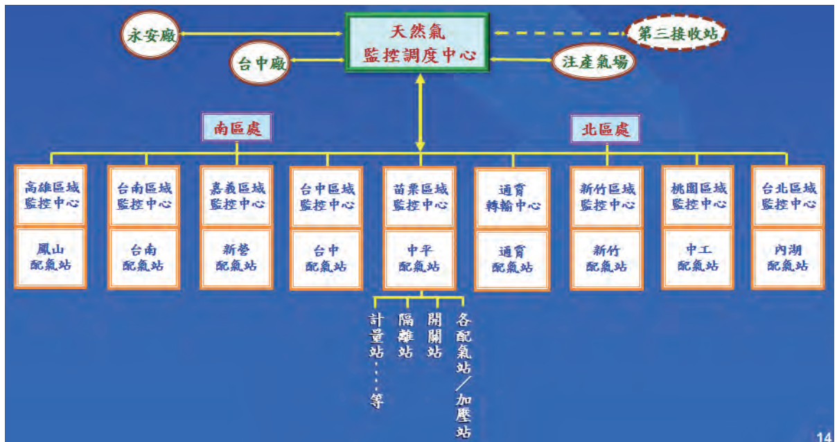
圖 1 整體天然氣監控調度架構圖
