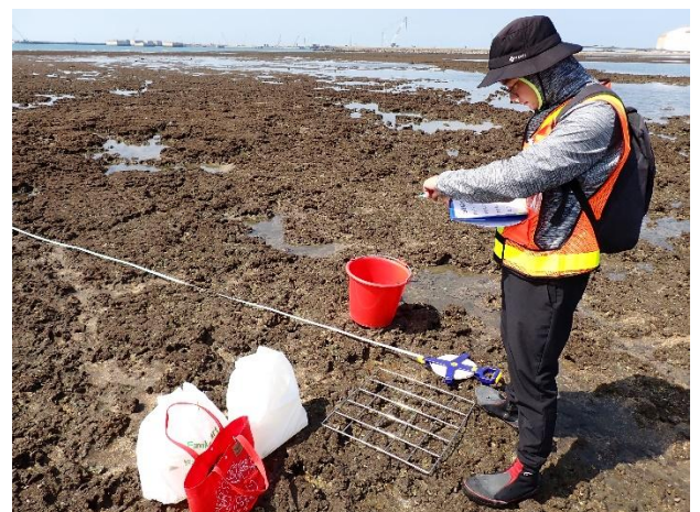
圖 2、以穿越線搭配樣框進行藻類調查。左圖為大潭 G2 測站低潮位，右圖為大潭 G2 測站高潮位
