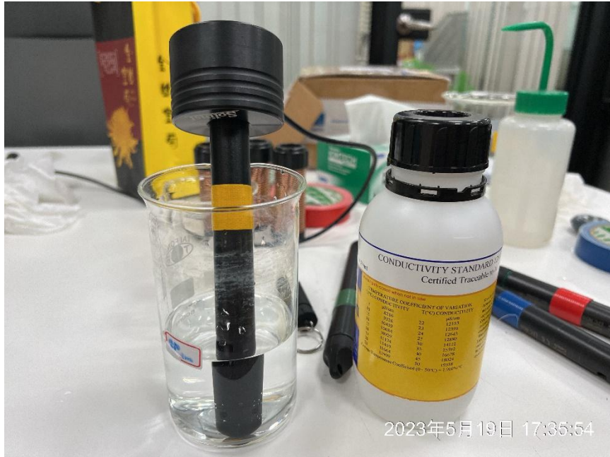
圖 2、導電度探頭校正工作照
