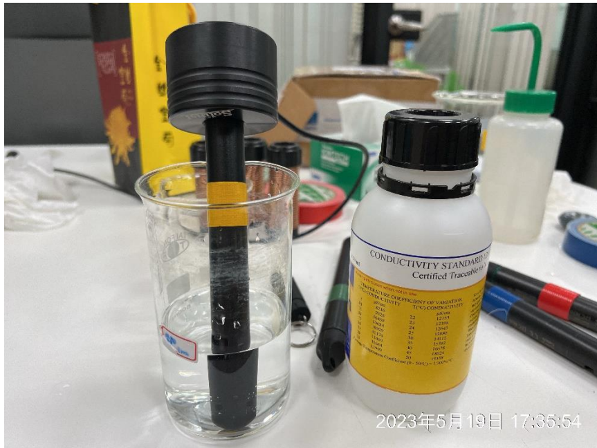
圖 2、導電度探頭校正工作照
