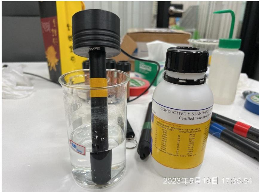
圖 2、導電度探頭校正工作照
