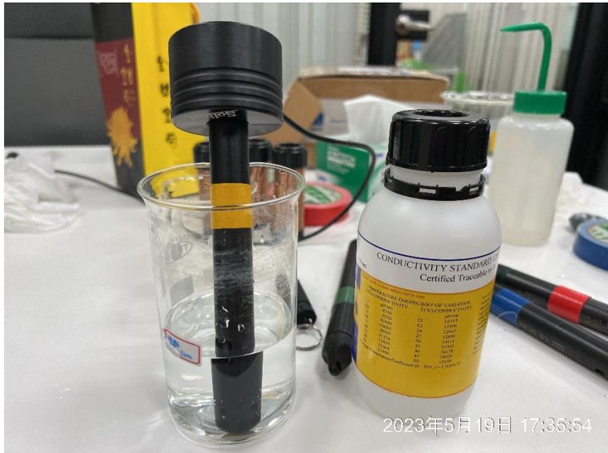
圖 2、導電度探頭校正工作照
