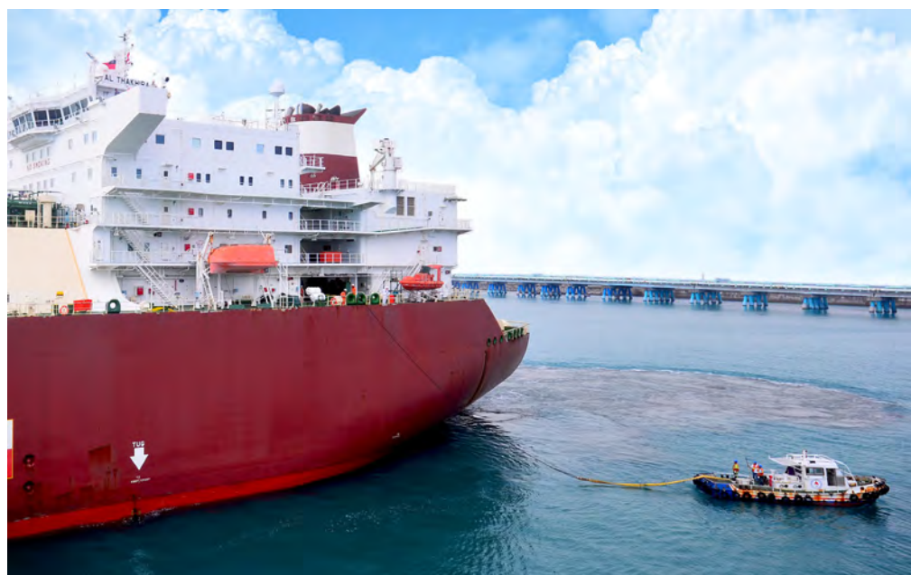
拖船的任務，是在繫泊船長登船引水時，分別駛在巨輪的前翼、側翼和後方，以纜繩拖 LNG 船入港。
