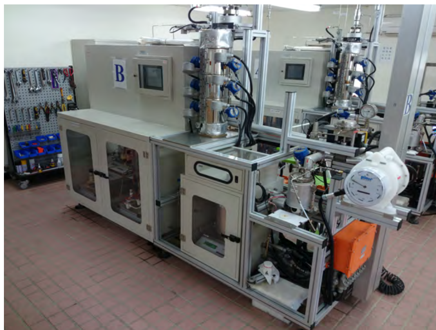
中油公司煉製研究所完成國內第一套小型天然氣重組製氫設備。
