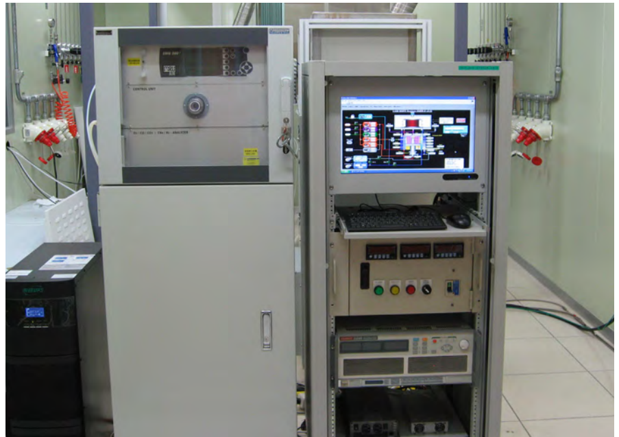
中油公司綠能所用來開發生產綠色柴油及生質航空燃油製程技術的高壓反應系統。
