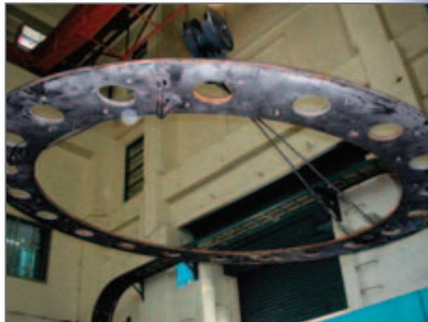
▲ 圖1 一邊吊耳脫落後，重新進行吊掛作業。
