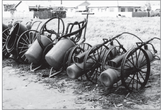
▲ 各類輪架式滅火器。
