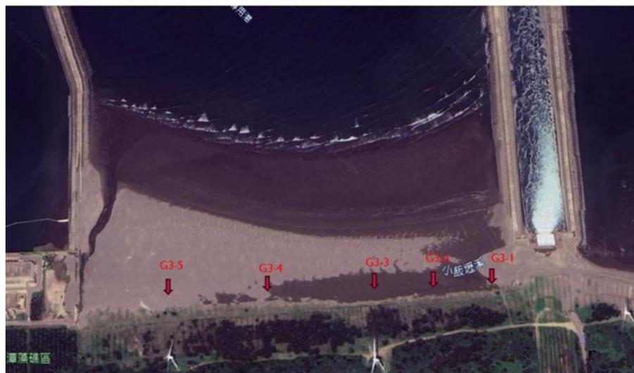
圖七、大潭 G1、G2（上圖）、G3（下圖）三區設置測量竹竿的位置
