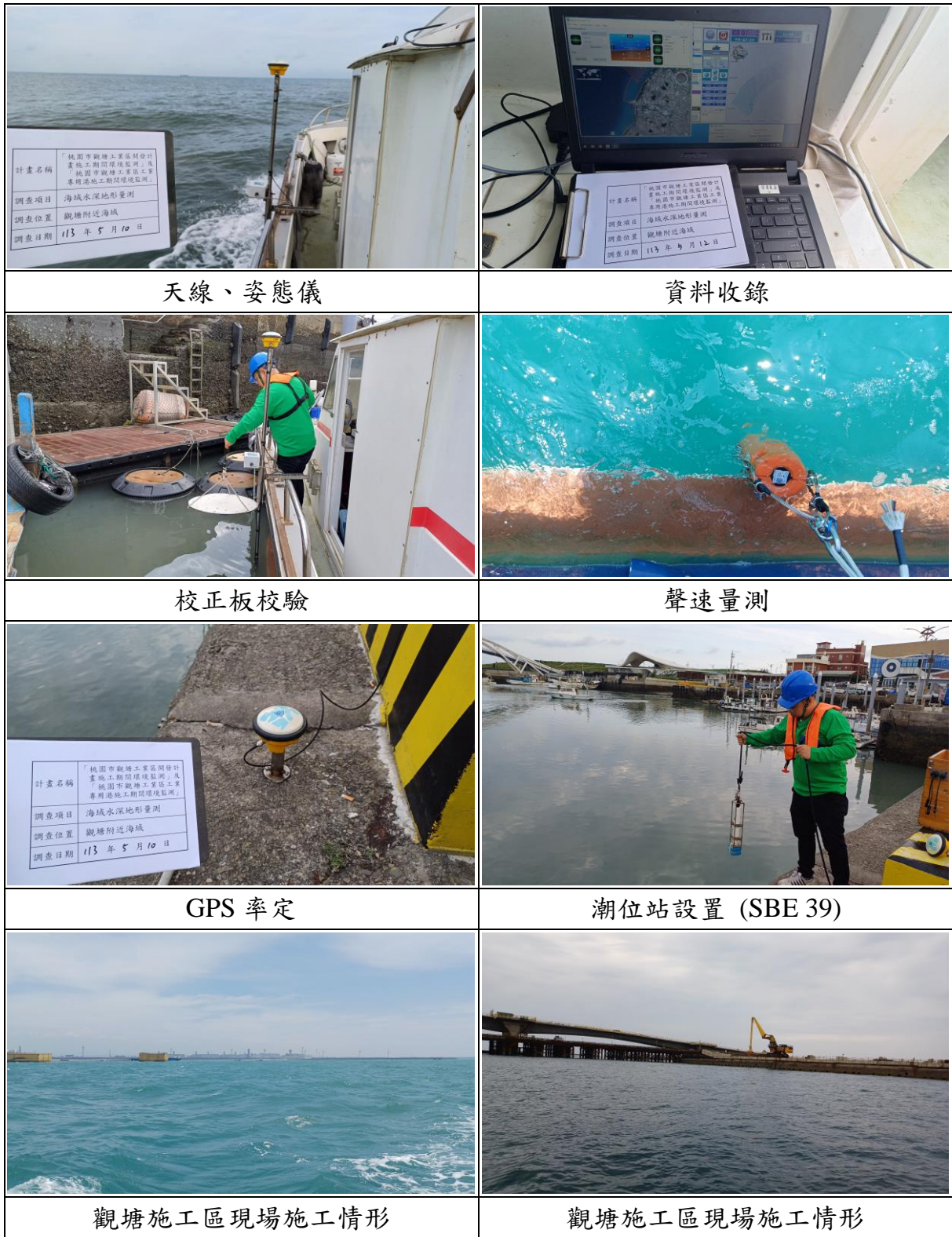
圖 2.12.2-1 海域地形測量現場作業相片
