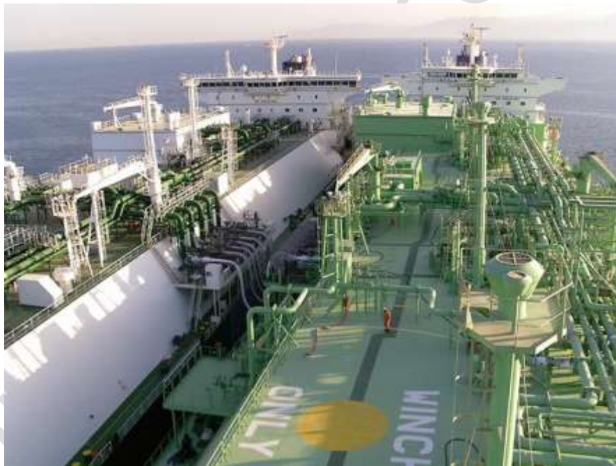
(b) FSRU BW Singapore 利用低溫軟管並排靠泊傳輸液態天然氣
