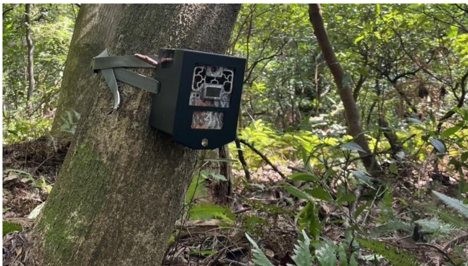
圖 6. 本研究使用紅外線自動感應式照相機
