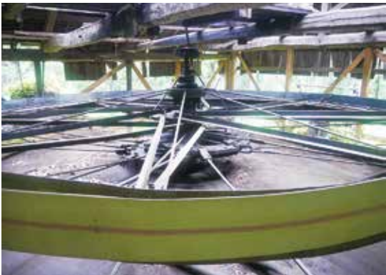
▲ Pumping Power 大轉盤及底下的偏心輪。
