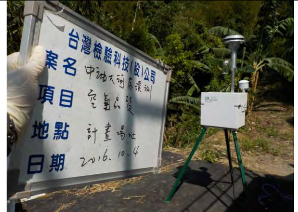
監測項目：空氣品質-PM 2.5 監測日期：105.10.04 監測地點：計畫場址
