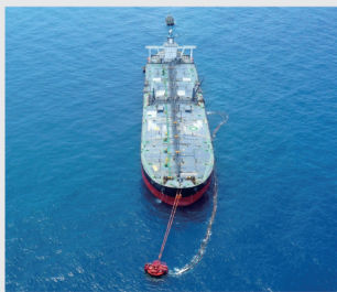
圖2大型油輪靠泊外海浮筒作業
