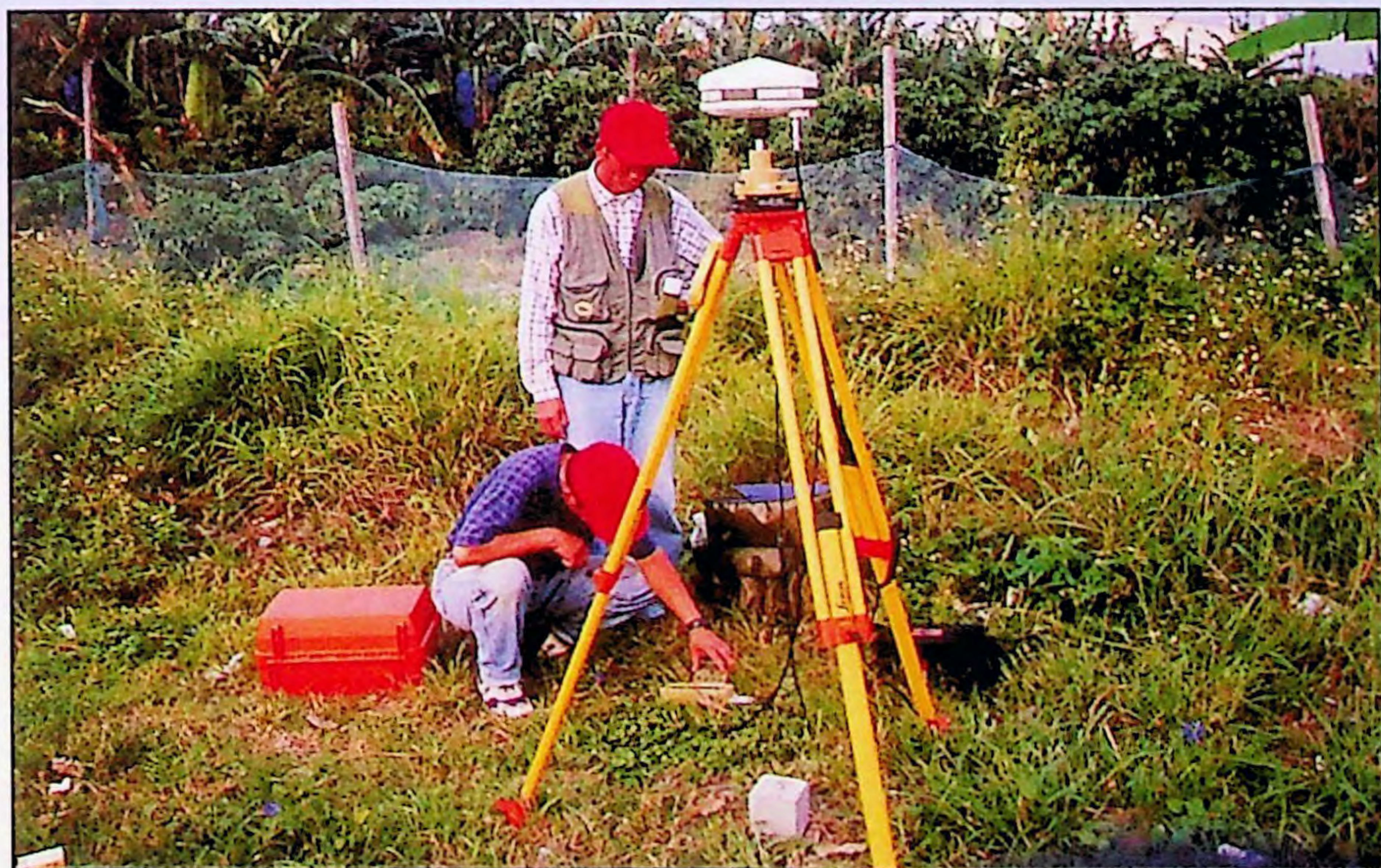
▲ 衛星定位測量，做控制點測量。
