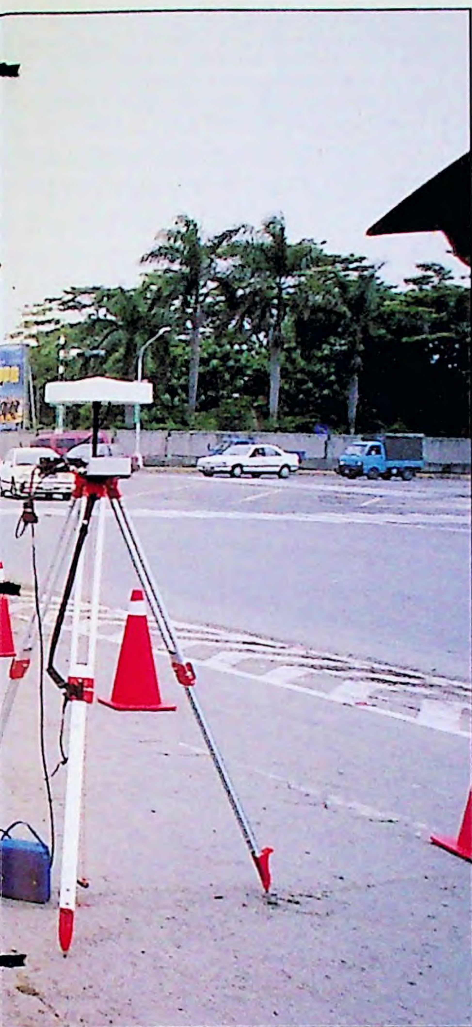
▲ 衛星定位測量，做控制點測量。
