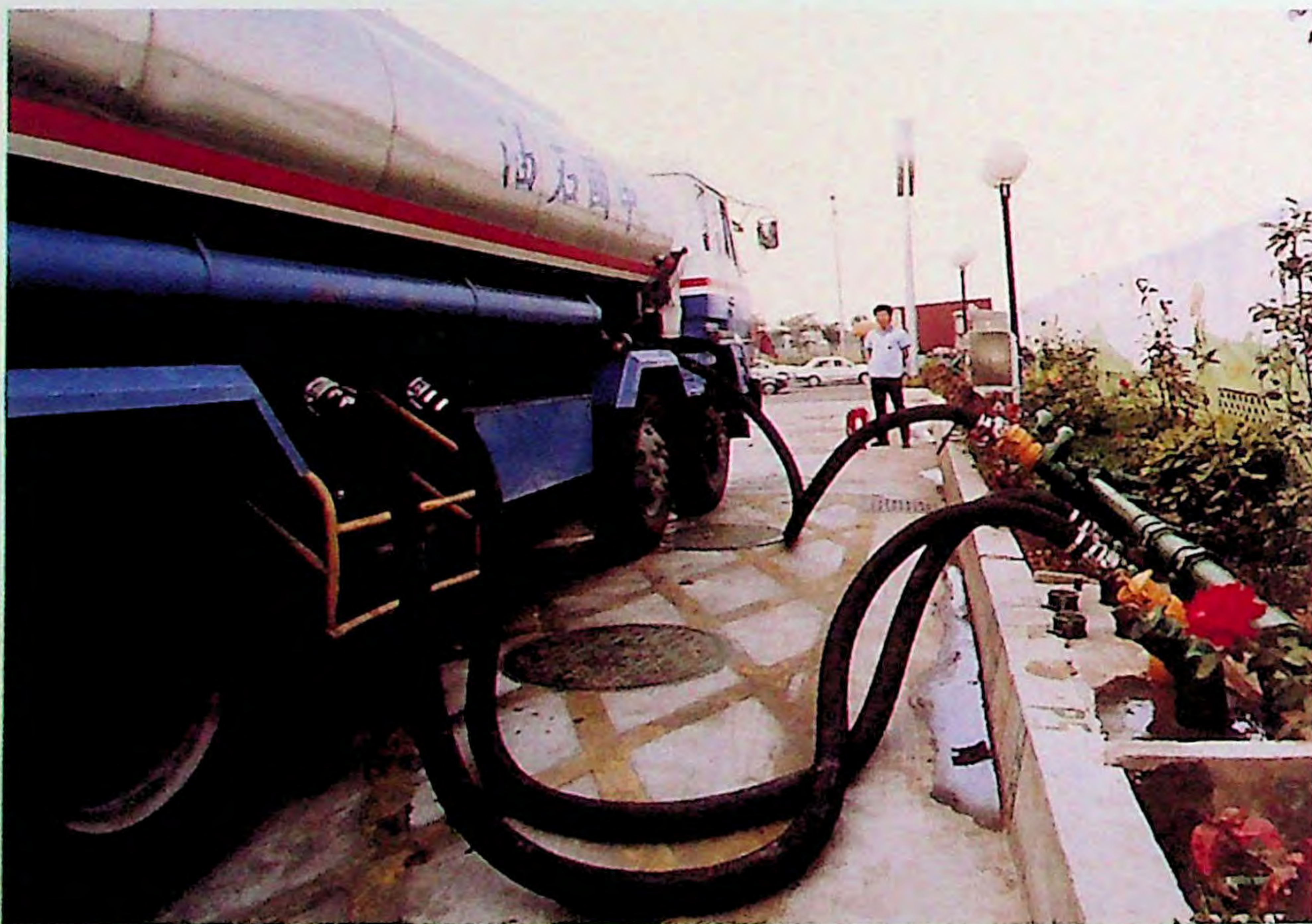
油罐車於卸油時回收油氣。
