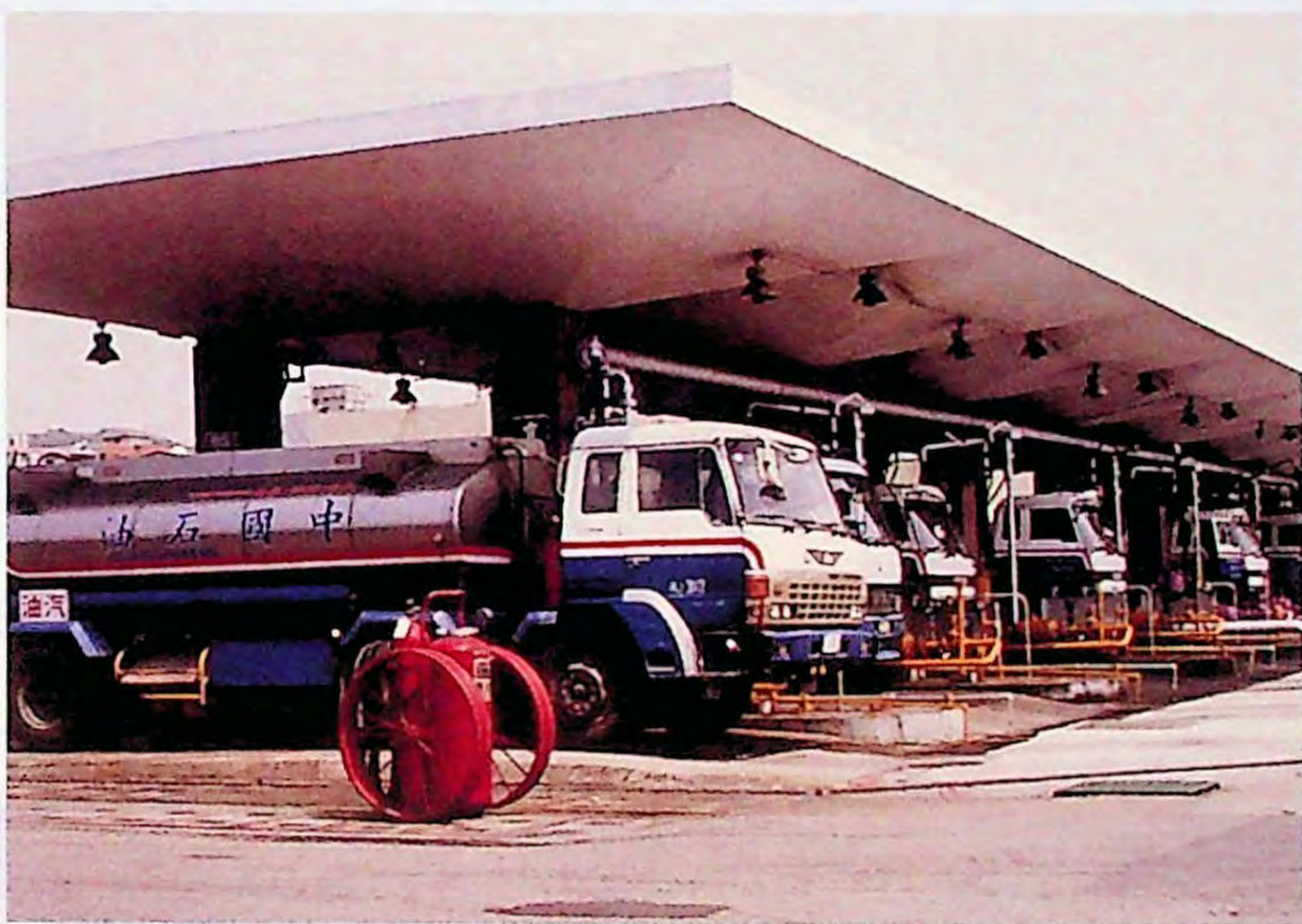
油罐車實施密閉式加、卸油，成效良好。
