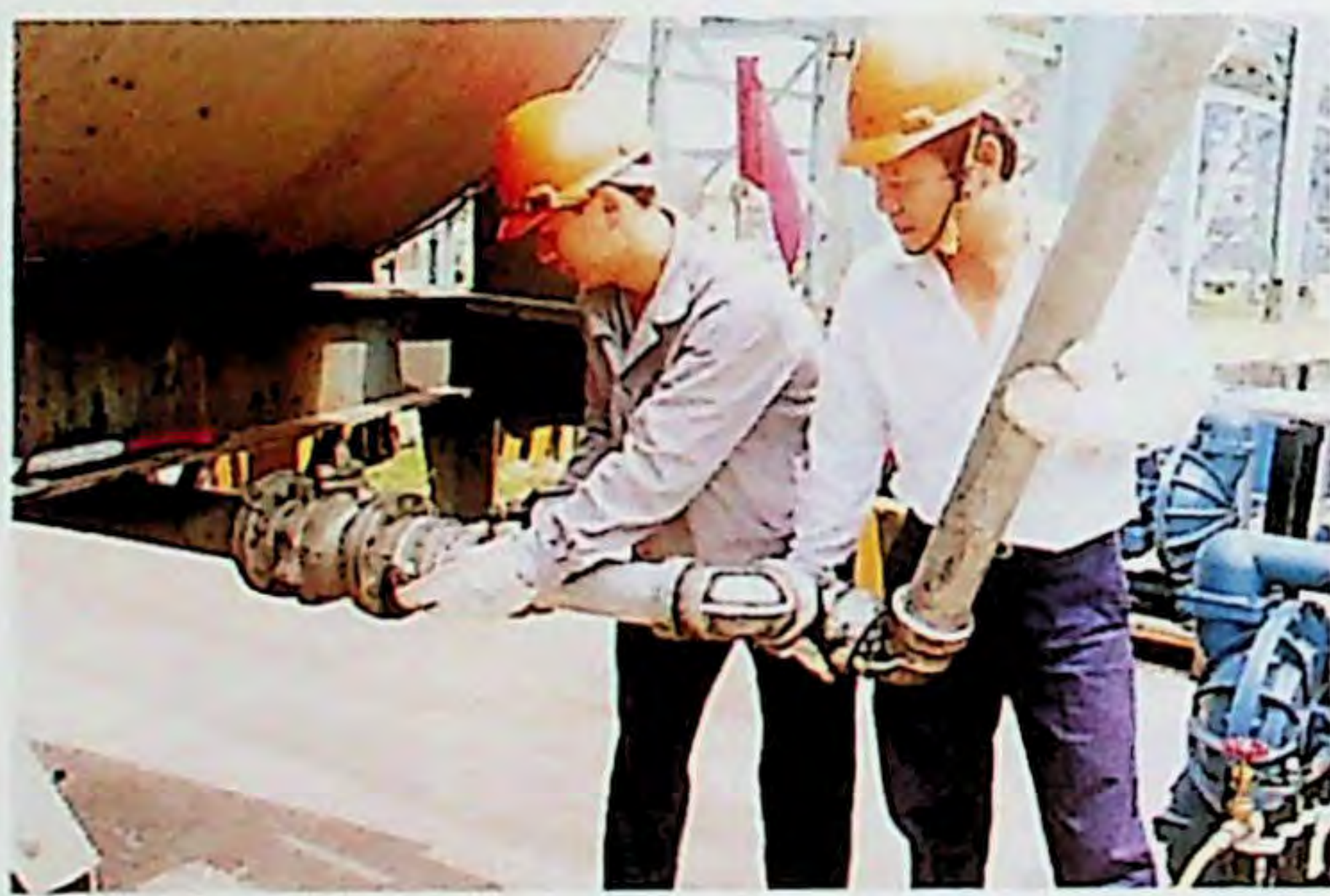
▲操作人員將灌裝臂接上槽車進口閥，準備灌裝Dinate。
