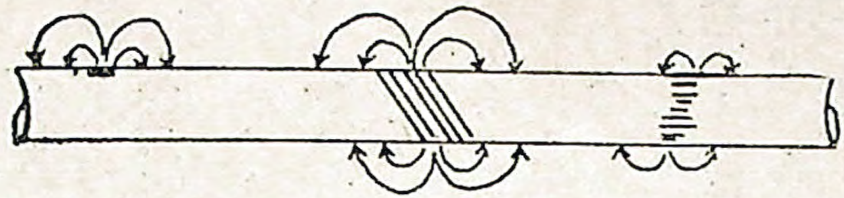
(圖十一) 管鉗痕跡及車絲等之侵蝕
