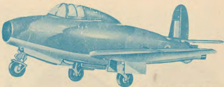
世界第一架成功的氣體渦輪噴射推進的 Gloster Whittle E-28 型飛機
